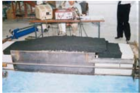
写真-2 改良供試体破壊形状
